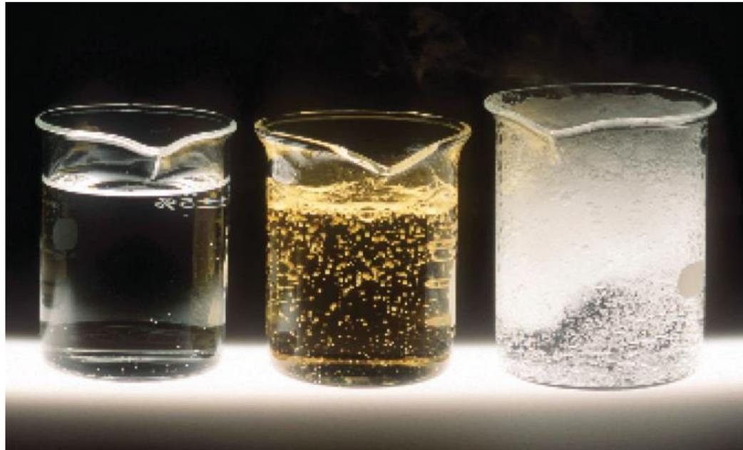
Uma solução de peróxido de hidrogênio ( $\text{H}_2\text{O}_2$ ) se decompõe na água tão lentamente que a mudança não é perceptível (esquerda). O íon iodeto atua como um catalisador para a decomposição de  $\text{H}_2\text{O}_2$ , produzindo gás oxigênio. A enzima catalase é muito mais eficaz que o iodeto como catalisador.
